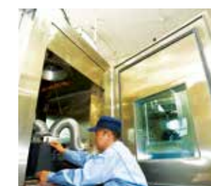
高加速寿命试验 (HALT): 用于确认耐热与振动极限的试验。
